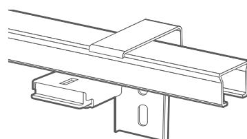
仮止めしたままカーテンレール取付金具をカーテンレールに挿入する。
